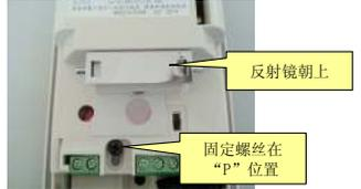
如果使用防宠物区域模式的话，请将探测器安装在1.2~1.5m高度范围内。
